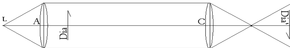
ABBILDUNG 1. Schema eines Dia-Projektors
